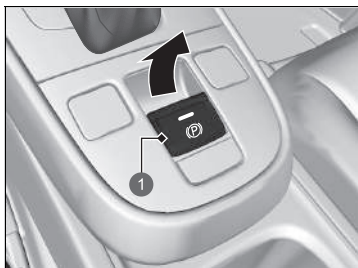
1 Spínač elektrické parkovací brzdy
