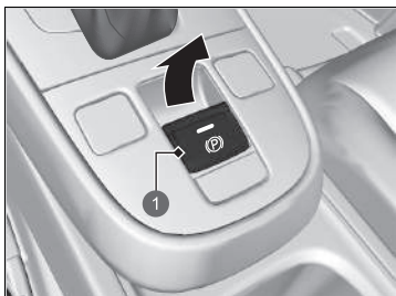
1 Spínač elektrické parkovací brzdy
