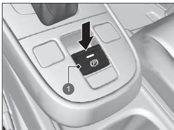
1 Spínač elektrické parkovací brzdy
